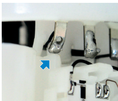
图 2: 由于燃油供给模块挤压过度，电缆脱出。
