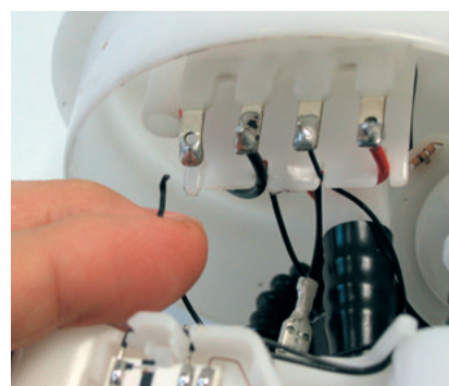
图 3: 典型损坏图: 油箱传感器的电缆松脱，电气触片弯曲。
